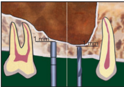
Abb. 5 (links) Für die Präparation des Implantatlagers werden bei Knochen vom Typ IV zunächst Osteotome und bei Knochen vom Typ III Spiralbohrer verwendet.
