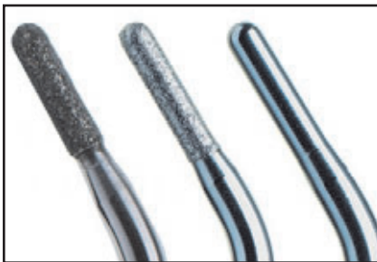
Abb. 6 Prototypen der abschließend entwickelten Ultraschallspitzen für die subgingivale Präparation (von links nach rechts): 76- \mu m-UDT, 46- \mu m-UDT, glatte Spitze.
