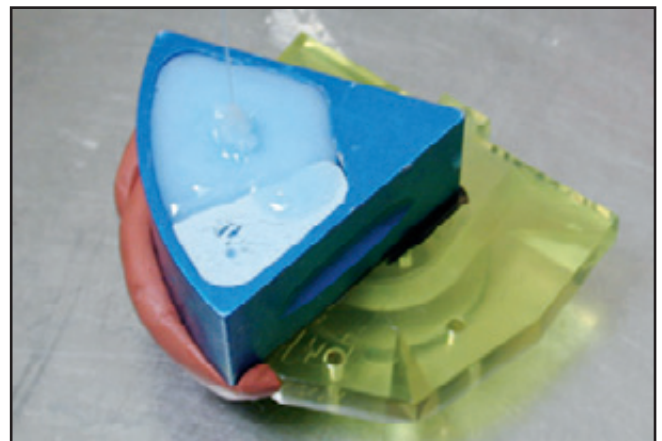
Abb. 6 Das additionsvernetzende Silikonmaterial wurde in die Küvette gegeben.
