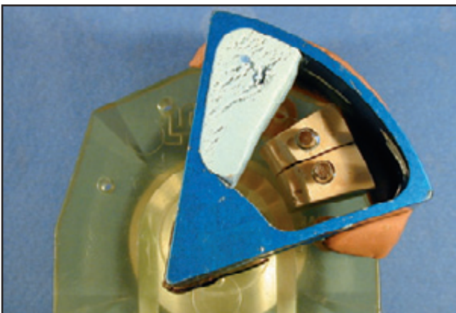
Abb. 5 Die Dublierküvette wurde auf die Sockelplatte montiert, einschließlich des zu dublierenden Teils.
