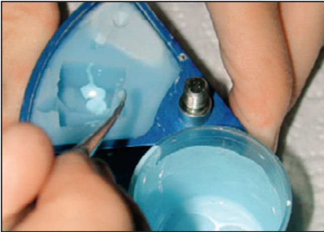
Abb. 7 Das Polyurethanharz wurde in die Silikonform gegeben.
