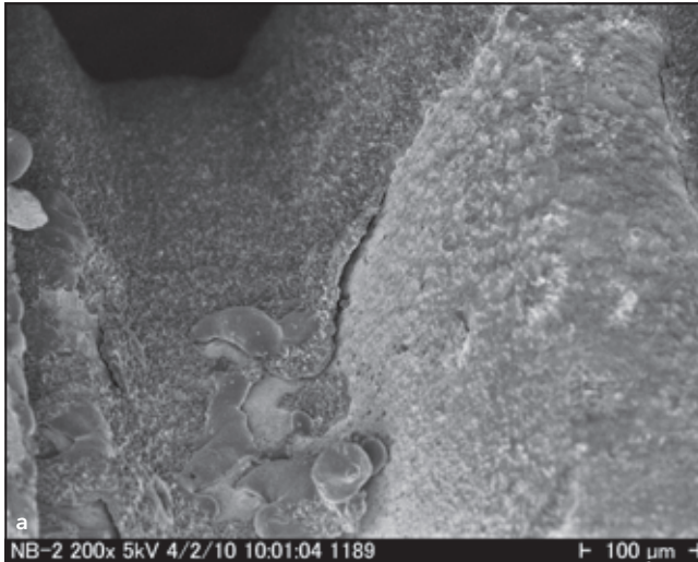
Abb. 1a bis c (a und b) Phasenkontrastmikroskopische Bilder. Die TiUnite-Schicht wurde vollständig durch Mikroexplosionen abgetragen. Die neu entstandene Oberfläche ist nicht geschmolzen oder anderweitig durch die Wärmeinwirkung des Lasers verändert. Im linken und oberen Abschnitt ist die Oberfläche vor der Bestrahlung mit dem Er:YAG-Laser zu erkennen, rechts und unten ist die Oberfläche nach der Laserung dargestellt. (c) Implantat nach Laserbehandlung des apikalen Anteils.
