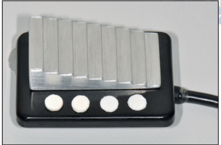
Abb. 1 Vier Zementscheiben und der Aluminiumstufenkeil auf einem digitalen Röntgensensor.
