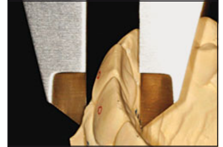
Abb. 11 Die Breitenmessung erfolgte an jedem Referenzpunkt mit einem digitalen Messschieber mit einer Genauigkeit von 0,01 mm.
